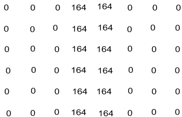
Figura 6.8: Bordos detectados en una imagen ausente de ruido
