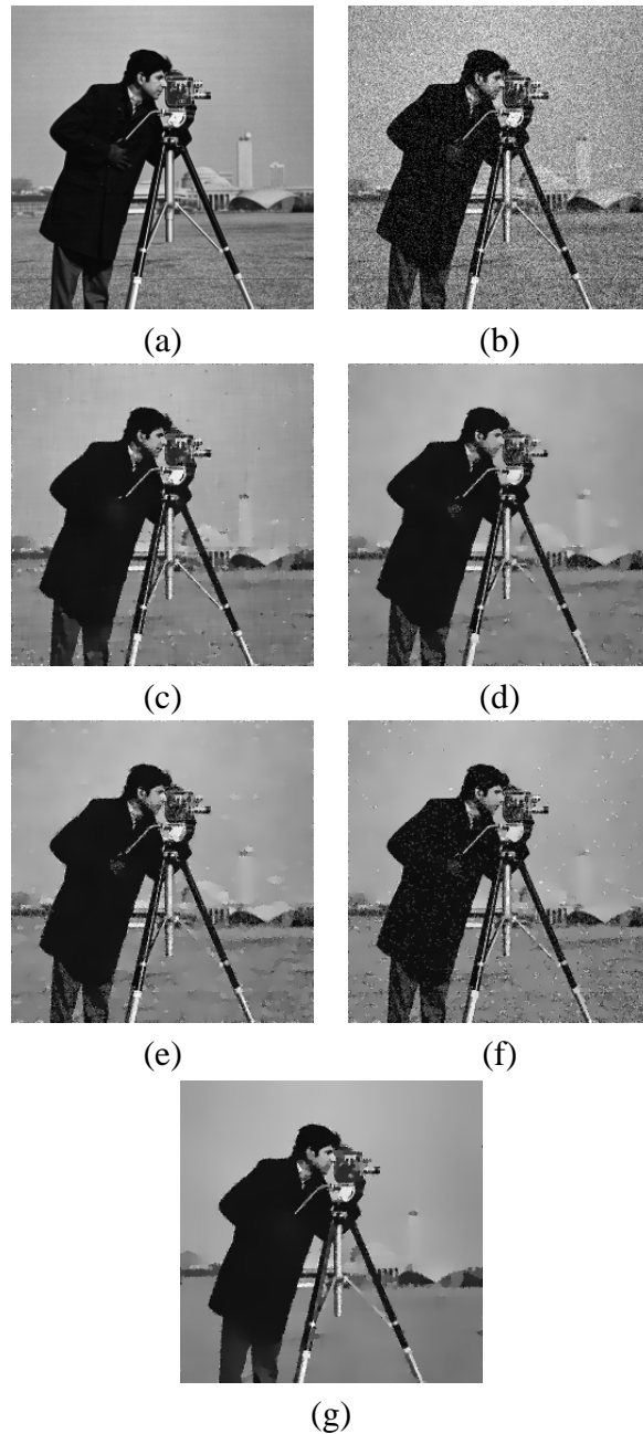
Figura 7.58: (a) Imagen ausente de ruido; (b) Imagen ruidosa ( \text{var} = 0.04 ); Imagen filtrada con: (c) nldif_borroso ; (d) nldif_borroso3 ; (e) nldif_borroso4 ; (f) nldif_borroso5 ; (g) versión original de Caté et al.
